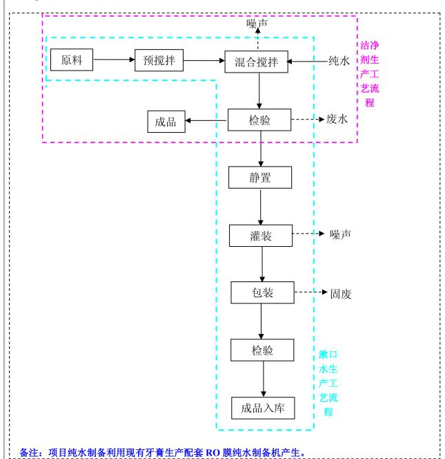
图2-2 项目生产工艺流程及产污环节
