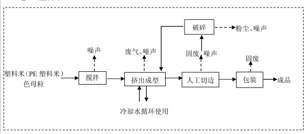
图 2-6 塑料制品生产工艺流程图
