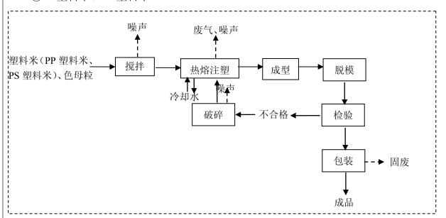
图 2-5 塑料制品生产工艺流程图
