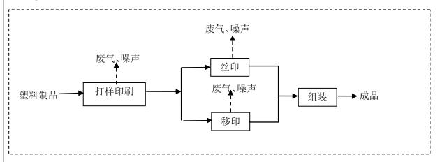
图 2-7 塑料制品印刷生产工艺流程图
