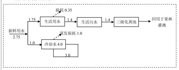
图 2-4 项目用排水平衡图 (t/d)
