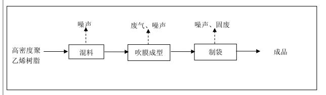
图 2-2 项目工艺流程图及产污环节示意图
