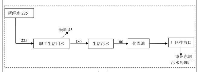
图 2-1 项目水平衡图 (t/d)
